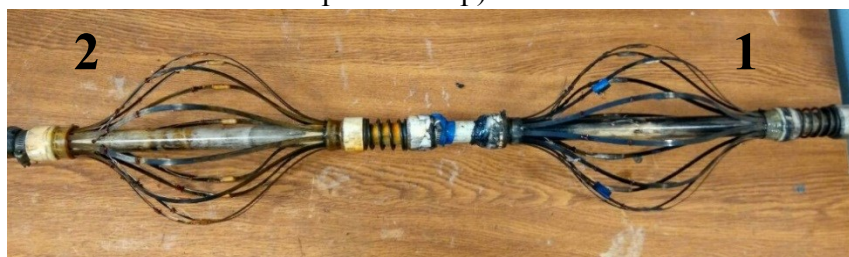
Рисунок 2 Азимутально распределенный температурный зонд (шифр: 1 – 1 уровень датчиков; 2 – уровень датчиков)
